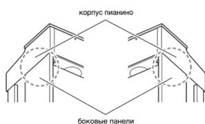
6. Двумя винтами ⑪ зафиксировать корпус пианино на стойке.
